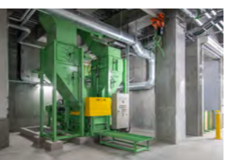
④ 缶類プレス機 選別したスチール缶、アルミ缶を圧縮して扱いやすい形状に整えます。
