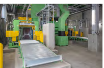
⑦ プラスチック製容器包装圧縮梱包機 プラスチック製容器包装をコンパクトに圧縮・梱包し、扱いやすい形状に整えます。
