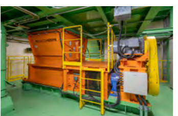
② 燃えないごみ粗破砕機 この後の工程での機械への負荷を減らすため、燃えないごみや不燃粗大ごみを40cm以下に粗く砕きます。
