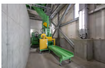
⑥ ペットボトル圧縮梱包機 ペットボトルをコンパクトに圧縮・梱包し、扱いやすい形状に整えます。
