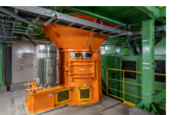
③ 高速回転破砕機 粗く砕いた燃えないごみや不燃粗大ごみを後工程で選別しやすくするため、15cm以下に細かく砕きます。
