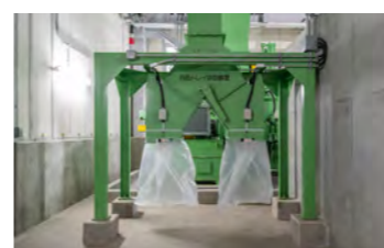
⑤ 白色トレイ袋詰装置 異物を取り除いた白色トレイを袋詰めします。
